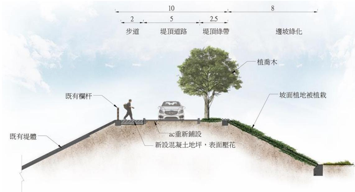
圖 3-1-10 外環堤頂步道標準斷面圖
